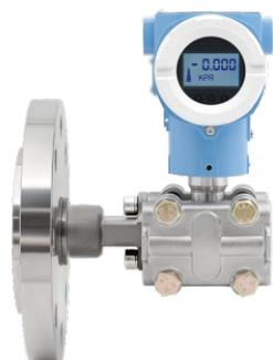
LFT720法兰安装式变送器结构上由LFT710差压变送器和经焊接安装的液位法兰组成，法兰与传感器之间采用硅油等填充液传递压力，避免被测介质通过引压管对测量造成的影响。被测介质通过引压管对测量造成的影响包括：结晶凝固汽化(沸腾)、冷凝、分馏(重度改变)等。用于测量液体气体或蒸汽的液位、流量和压力，然后将其转变成4~20mA DC信号输出。LFT720法兰安装式变送器其工作原理和LFT710差压变送器相同，只是正压侧压力传递途径略有不同：作用在高压侧的压力，首先经液位法兰的膜片和填充液，再经变送器本体，最后到达测量传感器的高压侧。
